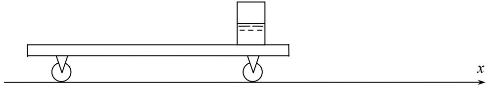
ной струей подается вода. По мере наполнения резервуара масса содержащейся в нем воды увеличивается и центр масс системы, состоящей из платформы и резервуара вместе с его содержимым, перемещается вправо по оси  $x$  (см. рисунок). При этом  $v_C = \dot{x}_C \neq 0$ . В то же время ни одна точка системы не движется по горизонтали ( $x_k = \text{const.}$ ), откуда
